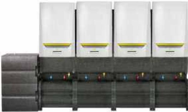
Sistema de distribución Paradigma para cascadas de calderas de hasta 4 PMA Maxi, que consiste en todos los componentes necesarios para el kit hidráulico de la cascada, junto con el aislamiento. El sistema es para el montaje de las calderas en pared. Posibilidad de conexión a derecha e izquierda. El kit hidráulico depende del número y la potencia de las calderas que lo componen.
