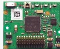
**Módulo inalámbrico ZigBee® / tarjeta Green Com.**
