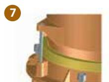
7 Introduzca la boca (A) colocándola de manera que el eje de los dos orificios de los estribos laterales coincida con los que se encuentran en la brida de tracción (E). Para facilitar la introducción de la boca (A) en la junta hermética (F), se aconseja utilizar un específico lubricante para tubos de plástico y juntas.
