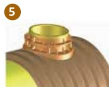
5 Una vez que ha introducido la brida de tracción (D) y asegurado su unión con el borde superior de la junta hermética (F), coloque los cuatro tornillos (C) en los orificios de brida de tracción (D) y enrósquelos hasta el asiento (E).
