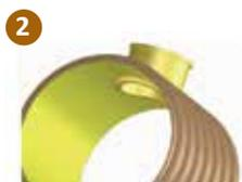
2 Después de preparar el tubo, introduzca la junta hermética (F) en el orificio (G) y gírela hasta que la superficie de su borde hermético se adhiera perfectamente a toda la superficie interna del tubo.
