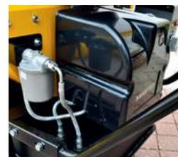
Cierre de depósito de combustible antifugas, con indicador de nivel
