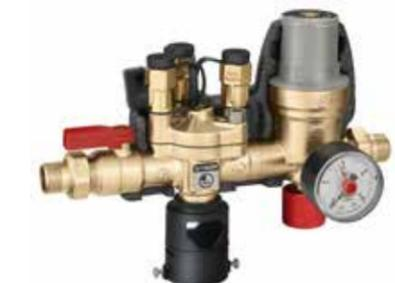
Grupo compacto de carga automático con desconector tipo BA, válvula de corte y filtro. Con aislamiento. Campo de regulación del grupo de llenado: 0,2÷4 bar. Presión máxima de servicio: 10 bar. Temperatura máxima de servicio: 65 °C.
