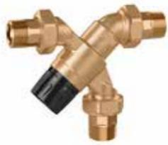
Mezclador termostático regulable con pomo, con válvulas de retención y filtros en las entradas. Con función de cierre térmico. Cuerpo en aleación antidezincificación "low lead" CR. Conexiones macho con enlace. Presión máxima de servicio: 10 bar. Temperatura máxima de entrada: 90°C. **Mexclador según las normas EN 1111 y EN 1287.**
