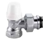
Detentor. Cromado. Conexiones en escuadra para tubo en hierro. Presión máxima de servicio: 10 bar. Campo de temperatura: 5÷100 °C.
