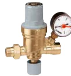
Grupo de llenado automático calibrable, antical, inspeccionable, con indicador de la presión de calibración, grifo, filtro, válvula antirretorno. Campo de regulación: 0,2÷4 bar. Presión máxima en entrada: 16 bar. Temperatura máxima de servicio: 65 °C.
