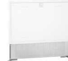
Caja para colectores de la serie 662, 671 y 668...S1 y grupos de la serie 182. Con soportes para la instalación en el suelo. Cierre con bloque de enganche rápido. En chapa pintada. Profundidad regulable de 110 a 150 mm. Altura regulable de 270 a 410 mm.
