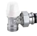
Detentor. Cromado. Conexiones en escuadra para tubo en cobre y plástico, monocapa o multicapa. Presión máxima de servicio: 10 bar. Campo de temperatura: 5÷100 °C.
