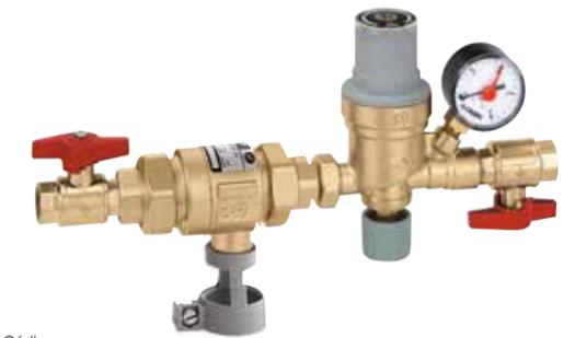
Grupo de carga automático con desconector tipo CA y válvulas de corte. Campo de regulación del grupo de llenado: 0,2÷4 bar. Presión máxima de servicio: 10 bar. Temperatura máxima de servicio: 65 °C. Desconector certificado según norma EN 14367.
