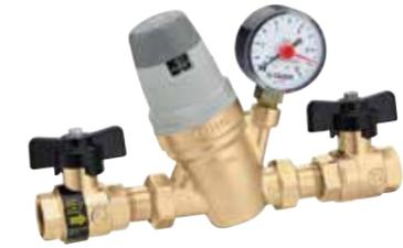
Grupo de llenado automático calibrable de gran capacidad, doble corte, válvula antirretorno. Cartucho monobloque con filtro extraíble. Campo de regulación: 1÷6 bar. Presión máxima en entrada: 16 bar. Temperatura máxima de servicio: 60 °C.
