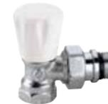
Válvula manual para radiadores. Cromada. Conexiones en escuadra para tubo en hierro. Presión máxima de servicio: 10 bar. Campo de temperatura: 5÷100 °C.
