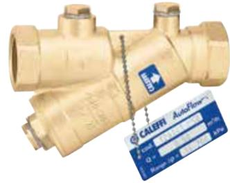
Estabilizador automático de caudal AUTOFLOW. Cuerpo en aleación antidezincificación CR. Cartucho AUTOFLOW: 1/2"±1 1/4" en polímero de alta resistencia, 1 1/2" y 2" en polímero de alta resistencia y acero inoxidable. Presión máxima de servicio: 25 bar. Campo de temperatura: -20÷100 °C. Porcentaje máximo de glicol: 50 %. Rango Δp: 15÷200 kPa. Caudales: 0,12÷11,0 m³/h. Precisión: ±10 %.
