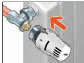
Remover el anillo de regulación y posicionar el comando termostático en la válvula.
