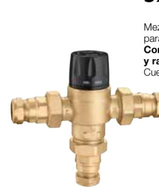
Mezclador termostático regulable, para instalaciones centralizadas. **Con válvulas de retención en las entradas y racores bicono.** Cuerpo en aleación antidezincificación CR. Regulador interno antical en tecnopolímero. Presión máxima de servicio: 14 bar. Temperatura máxima de entrada: 90°C.
