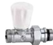
Válvula manual para radiadores. Cromada. Conexiones rectas para tubo en cobre y plástico, monocapa o multicapa. Presión máxima de servicio: 10 bar. Campo de temperatura: 5÷100 °C.
