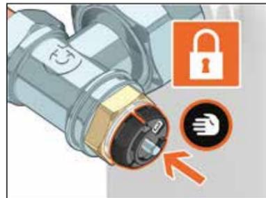
Posicionar el grifo manual, el mando termostático o el electrotérmico sobre la válvula.
