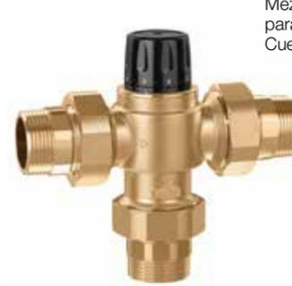
Mezclador termostático regulable, para instalaciones centralizadas. Cuerpo en aleación antidezincificación CR. Regulador interno antical en tecnopolímero. Presión máxima de servicio: 14 bar. Temperatura máxima de entrada: 90°C.
