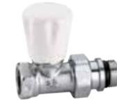
Válvula manual para radiadores. Cromada. Conexiones rectas, para tubo en hierro. Presión máxima de servicio: 10 bar. Campo de temperatura: 5÷100 °C.
