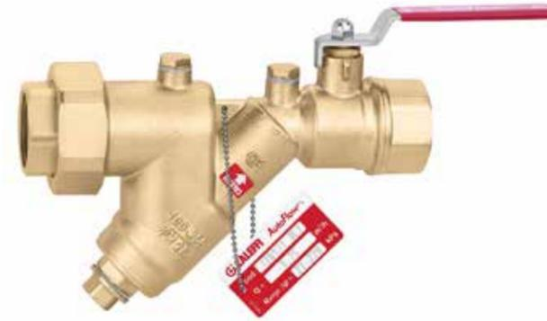
Combinación de estabilizador automático de caudal y válvula de esfera. Cuerpo en aleación antidezincificación CR. Cartucho AUTOFLOW en acero inoxidable. Presión máxima de servicio: 25 bar. Campo de temperatura: 0÷110 °C. Porcentaje máximo de glicol: 50 %. Rango Δp: 7÷100 kPa; 22÷220 kPa; 35÷410 kPa. Caudales: 0,12÷15,5 m³/h. Precisión: ±5 %.
