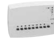
Receptor de pared. 8 canales - 868 MHz. Alimentación: 16÷18 V (mediante barra de mando). Potencia absorbida: 1 VA. Salida Bus 8+1 para mando/control bomba. Grado de protección: IP 30.
