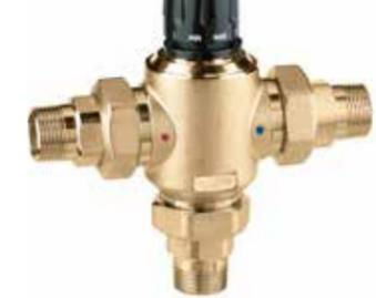
Mezclador termostático regulable con cartucho sustituible, para instalaciones centralizadas. Cuerpo en latón. Presión máxima de servicio: 14 bar. Temperatura máxima de entrada: 85°C.
