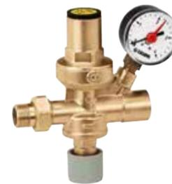
Grupo de llenado automático con grifo, filtro, válvula antirretorno. Campo de regulación: 0,3÷4 bar. Presión máxima en entrada: 16 bar. Temperatura máxima de servicio: 70 °C.
