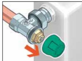
Para efectuar la pre-regulación del caudal, posicionar la pieza en forma de anillo.
