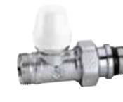
Detentor. Cromado. Conexiones rectas para tubo en cobre y plástico, monocapa o multicapa. Presión máxima de servicio: 10 bar. Campo de temperatura: 5÷100 °C.
