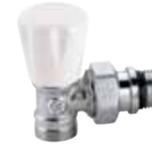
Válvula manual para radiadores. Cromada. Conexiones en escuadra para tubo en cobre y plástico, monocapa o multicapa. Presión máxima de servicio: 10 bar. Campo de temperatura: 5÷100 °C.
