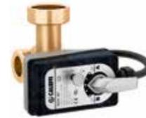
Válvula de tres vías de sector (control equiporcentual/lineal) y servomotor de tres puntos. **Versión derecha.** Presión máxima de servicio: 10 bar. Temperatura máxima de servicio: 100 °C. Conexiones: 1 1/2" M x 1 1/4" M x 1 1/2" H con tuerca.
