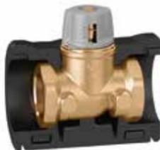
Válvula de corte y prerregulación. Cuerpo en aleación antidezincificación CR. Dotada de tomas de presión para la conexión del tubo capilar. **Con aislamiento.** Presión máxima de servicio: 16 bar. Campo de temperatura: -10÷120 °C. Porcentaje máximo de glicol: 50 %.
