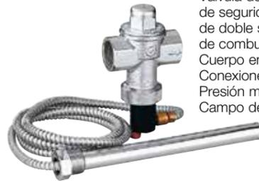
Válvula de descarga de seguridad térmica con sensor de doble seguridad para generadores de combustible sólido. Cuerpo en latón. Cromado. Conexiones roscadas hembra. Presión máxima de servicio: 10 bar. Campo de temperatura: 5÷110 °C.
