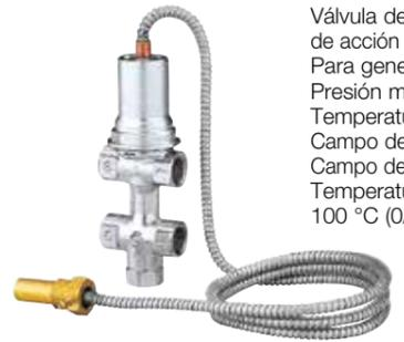
Válvula de descarga térmica de acción positiva con relleno incorporado. Para generadores de combustible sólido. Presión máxima de servicio: 6 bar. Temperatura máxima de servicio: 110 °C. Campo de temperatura: 5÷110 °C. Campo de temperatura ambiente: 1÷50 °C. Temperatura máxima de calibración: 100 °C (0/-5 °C).
