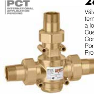
Válvula anticongelación con control termostático de la temperatura de retorno a los generadores de combustible sólido. Cuerpo en latón. Conexiones macho con enlace. Porcentaje máximo de glicol: 50 %. Presión máxima de servicio: 10 bar. Campo de temperatura: 5÷100 °C. Calibraciones (Tset): 45 °C, 55 °C, 60 °C, 70 °C. Precisión calibración: ±2 °C. Temperatura de cierre total del by-pass: Tmix = Tset + 10 °C = Tr.
