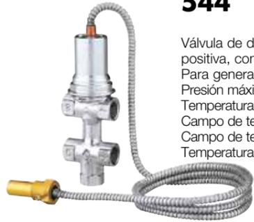
Válvula de descarga térmica de acción positiva, con relleno incorporado. Para generadores de combustible sólido. Presión máxima de servicio: 6 bar. Temperatura máxima de servicio: 110 °C. Campo de temperatura: 5÷110 °C. Campo de temperatura ambiente: 1÷50 °C. Temperatura de calibración: 100 °C (0/-5 °C).
