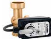
Válvula de tres vías de sector (control equiporcentual/lineal) y servomotor de tres puntos. **Versión izquierda.** Presión máxima de servicio: 10 bar. Temperatura máxima de servicio: 100 °C. Conexiones: 1 1/2" M x 1 1/4" M x 1 1/2" H con tuerca.
