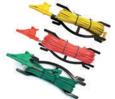
Cables medición resistencia tierra
