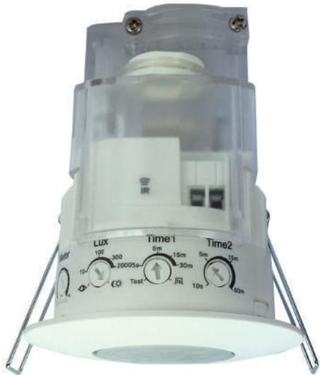
El **KDP KNX 01** es un detector de presencia integrado (PIR), detector de movimiento y detector de nivel de intensidad lumínica. Diseñado para incorporar el sistema de control de casa y construcción KNX y ser utilizado para aplicaciones de iluminación y de HVAC con el fin de optimizar y ahorrar energía.
